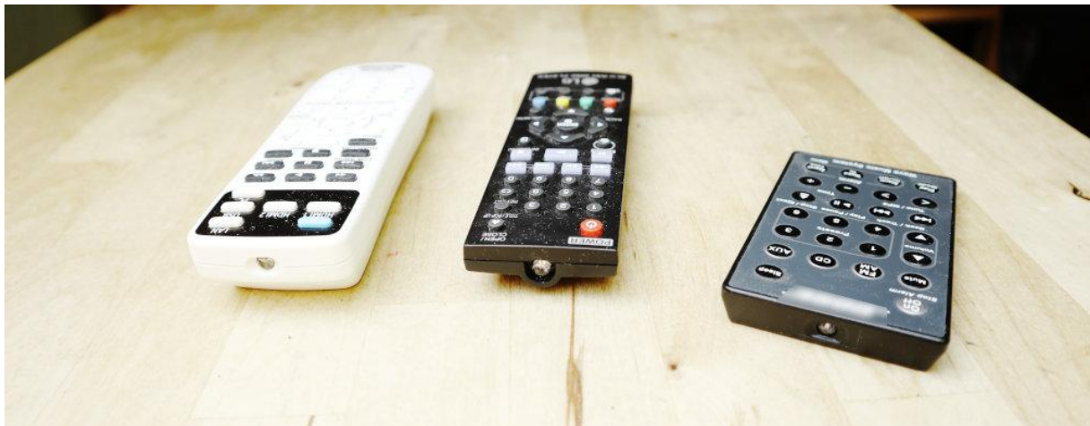
Drei Nahinfrarot-Fernbedienungen. Die Nahinfrarot-Lichtquelle ist auf den schmalen Vorderseiten jeweils als durchscheinendes, abgerundetes Gebilde zu sehen.
